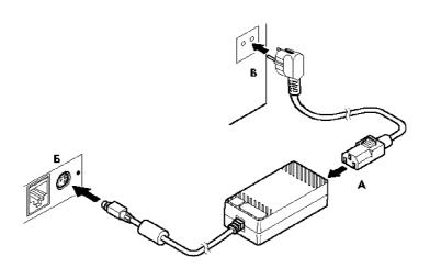
Рисунок 4 Подключение кабелей питания
