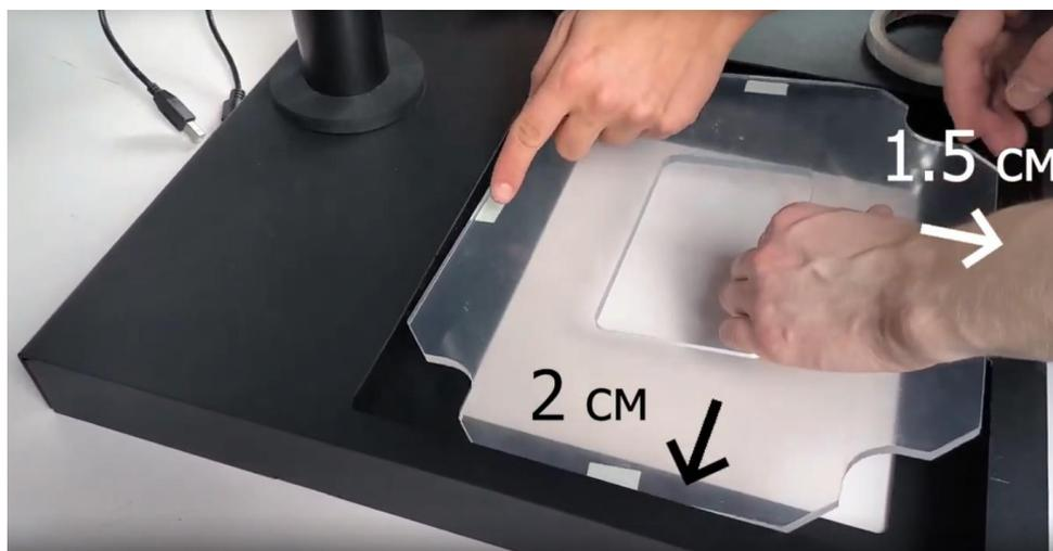
*Для закрепления подложки в металлическую платформу комплекса этикетирования, можно использовать 2-х сторонний скотч или универсальный клей.*
